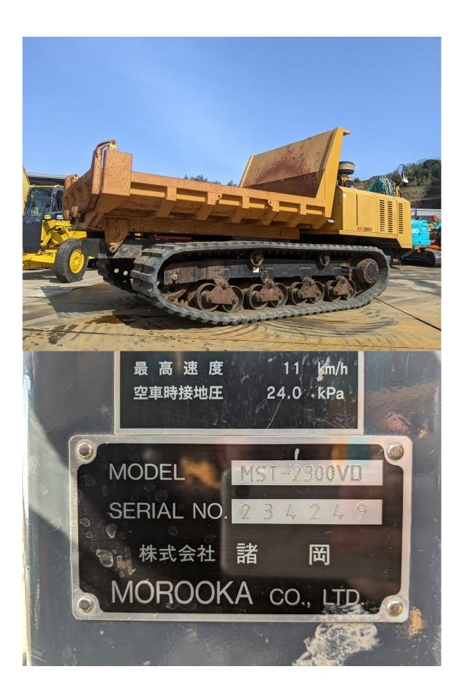
234249 種 MST=2300VD-IVA 機 製造者名株式会社諸 岡 最大積載量 11000 kg 機械総質量 24830 kg 安定度(左右) 35° 安定度(左右) 定格出力 186 kW 最高速度 11 km/h 24.0 . kPa 空車時接地圧
